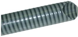
Tuyau en pvc nitrile plastifié renforcé d'une spirale en pvc rigide, convient pour l'aspiration et le refoulement d'hydrocarbures. Opal a une grande maniabilité caractérisée par sa souplesse même à basse température.
